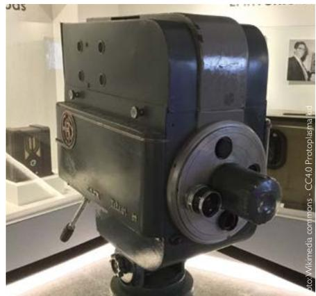
Cámara GonCam para el Adaptador Cromoscópico para Aparatos de Televisión, sistema de transmisión televisiva pionero a color. Museo de la Radio y Televisión, Palacio de la Cultura y la Comunicación, Zapopan, Jalisco.
